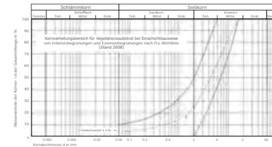
Abb. 4: Sieblinienband nach FLL 2010, Material: hygrocotta® I Extensivsubstrat
