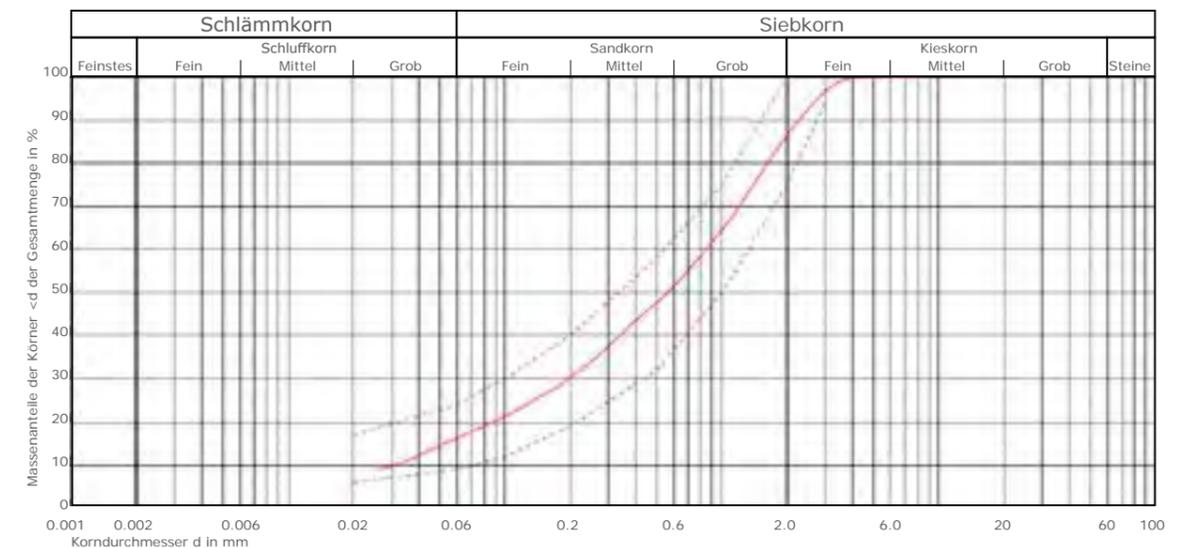
Abb. 5: Sieblinienband nach DIN 18035/5 Material: poracotta® Tennenbelag 0/3
