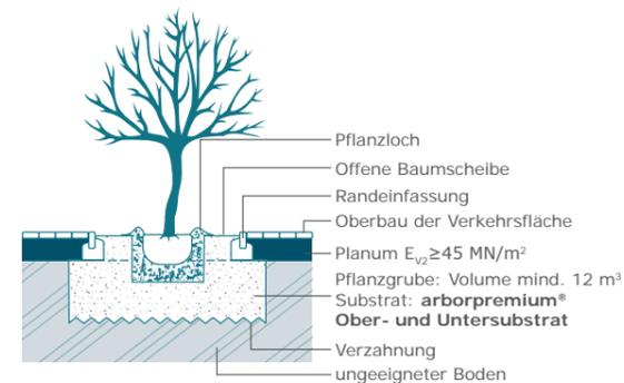
Abb. 3: Pflanzgrubenbauweise 2 (frei nach FLL)
