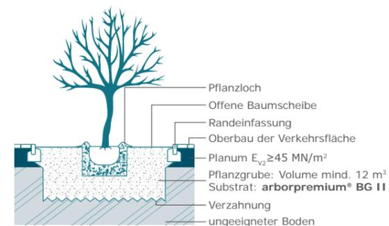
Abb. 2: Pflanzgrubenbauweise 1 (frei nach FLL)
